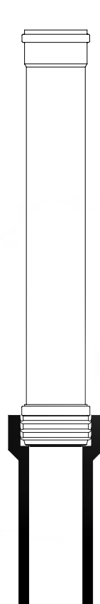
Übergang von POLO-KAL NG-Spitzende auf Faserzement-Muffe
